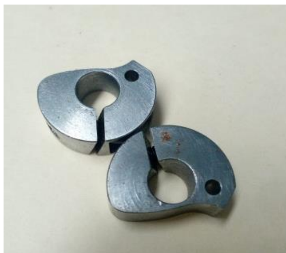
DESCRIPCIÓN: EXCENTRICO (CONTROL CAM) # DE PARTE: 0396-351393
